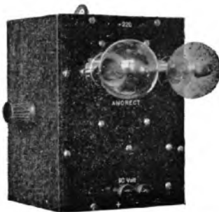
De gelijkrichter, zooals hij thans door de fa. Smith en Hooghoudt, in den handel wordt gebracht.
